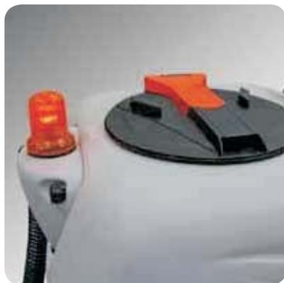
Бак с люком и быстрозажимным замком можно быстро и просто опустошать и промывать; бак можно наклонять и полностью сливать через шланг большого диаметра и вымывать все отложения из бака. Противопенное устройство защищает всасывающий мотор, а электронный поплавковый выключатель останавливает всасывание при наполнении бака
