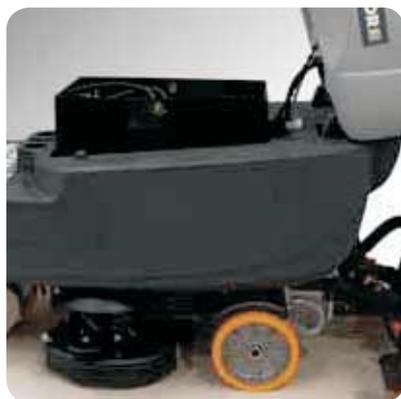
80 кг постоянного давления на щетки и система самовыравнивания для удаления любых загрязнений с любых типов полов.
