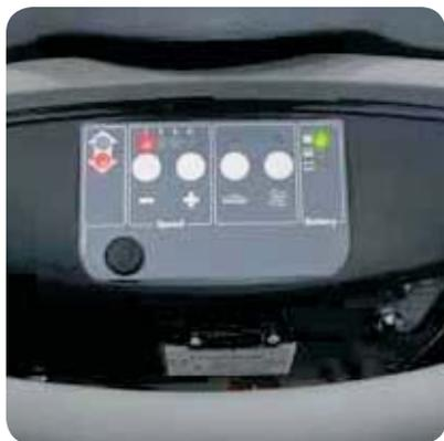
Эргономичная панель управления. Регулятор скорости движения. Основной ВКЛ./ВЫКЛ и ключ, кнопки включения привода щетки и вакуумного мотора. Термопредохранители вакуумного насоса и мотора привода щетки, индикатор уровня заряда батарей, счетчик мото-часов.
