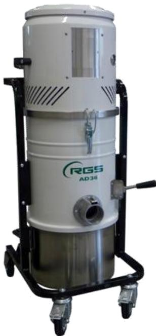
Промышленные пылесосы серии "AD" предназначены для применения в тех местах, где электроэнергия отсутствует или запрещена, приводятся в действие от сжатого воздуха и не имеют механизмов с электрическим приводом.
